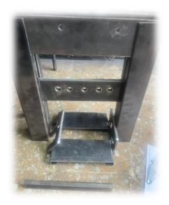
Ilustración 39. *Mecanizado y aplicación de cordón de soldadura base del adoquín*. Fuente: Elaboración propia.
