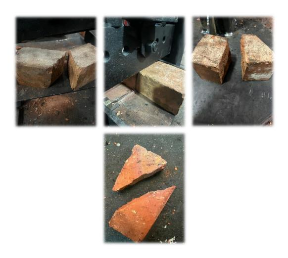
Ilustración 46. Geometría de corte. Fuente: Elaboración propia
