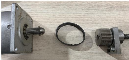
**Figura A.0.13:** . Transmisión eje Z
