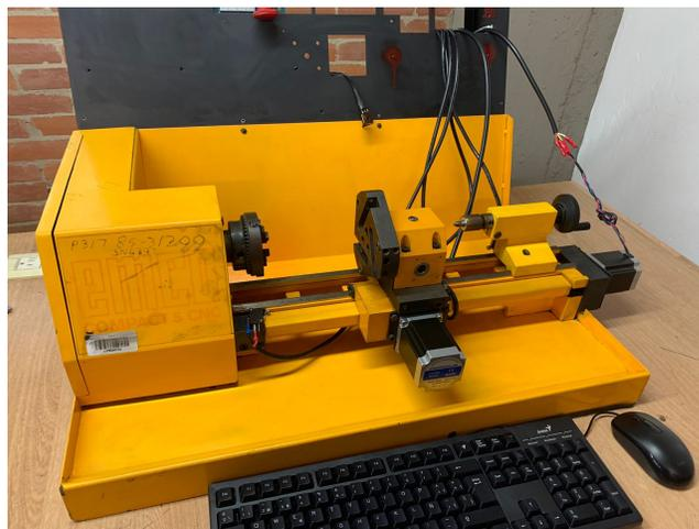
**Figura 3.5.2:** Montaje de Motores paso a paso
