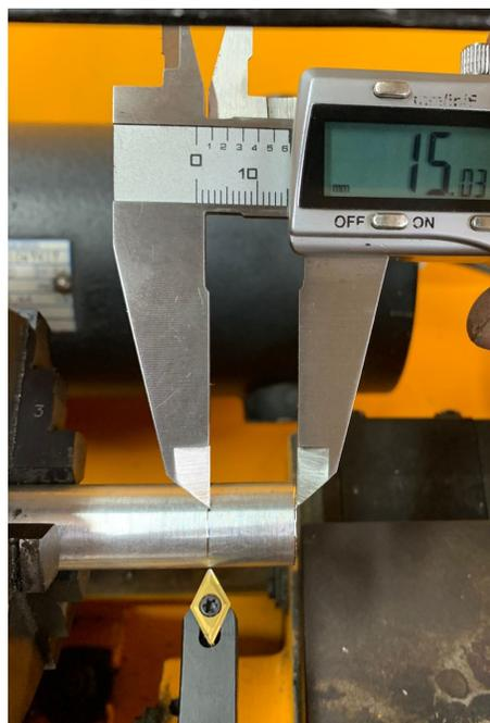
**Figura 4.5.1:** Precisión en eje Z
