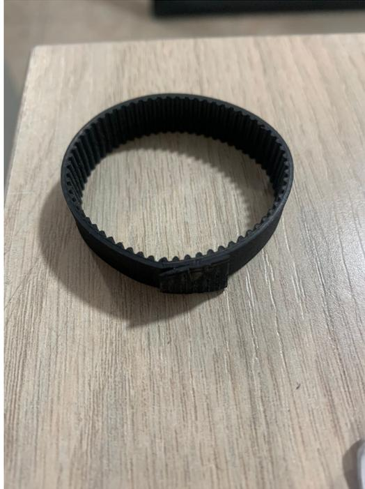
**Figura 4.4.2:** Segunda prueba unión correa
