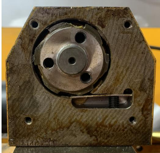
**Figura A.0.15:** . Mecanismo de torrera con seguro
