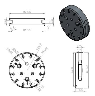
La herramienta de montura de agua está dividida en dos partes (figura 22 y figura 23), se ensamblan manualmente y esta herramienta de acople es la encargada de redistribuir uniformemente el agua en un diámetro de 94 *mm*.
