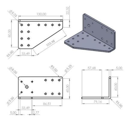
La tarea principal del plato de desplazamiento y sujeción entre eje Z y eje Y es permitir el desplazamiento en el eje Y gracias al ensamble de un motor paso a paso y acople de poleas y correas dentadas, adicionalmente tiene ensamblado 7 rodamientos para el eje Y y 5 rodamientos para el eje Z, esto con el fin de poder generar su desplazamiento.
