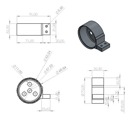
La herramienta de montura universal (HIM) consta de dos partes (figura 19 y figura 20), estas herramientas van ensambladas en el eje Z. Vienen acopladas tres mangueras, en una de ellas viene incorporado el cable UTP utilizado para realizar las conexiones electrónicas, las dos mangueras restantes son: manguera de succión de aire y la manguera donde fluye el agua.
