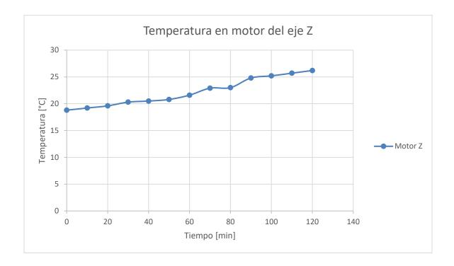
Los motores de los ejes X, Y y Z estuvieron sometidos durante 2 horas a estrés continuo (corriente máxima) y denoto un aumento de temperatura que no es considerable para determinar un posible daño por sobrecalentamiento a causa del uso continuo de estos mismos motores debido a factores como fuerzas y fricción.
