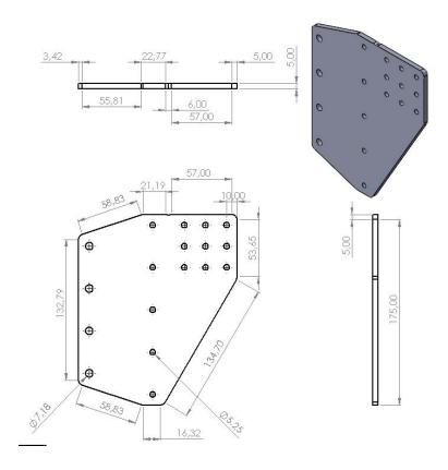
El plato de sujeción entre eje Y y eje X son los encargados de unir la estructura entre dos motores paso a paso en el eje X y el perfil de aluminio 2060 V-slot y que se ocupan en generar el desplazamiento en el eje X mediante el acople de poleas y correas dentadas.
