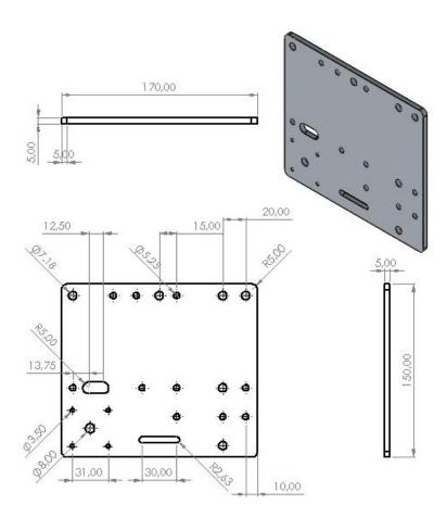
El soporte de sujeción eje Z fue diseñado con el fin de ensamblar el motor paso a paso hacia el eje Z, para originar el desplazamiento en este eje gracias a un acople de 8 mm conectado entre el motor paso a paso y una varilla roscada de 8mm.
