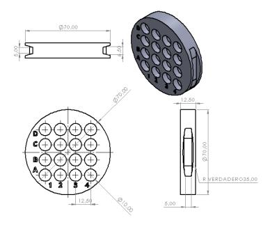
La herramienta matricial semillero es la única herramienta que no fue diseñado con el fin de acoplar y desacoplar. La función de esta herramienta es permitir la siembra de hasta 16 tipos de semillas. Esta herramienta cuenta con un diseño matricial 4 por 4, donde las filas y columnas están nombradas y enumeradas. Esto permite identificar la posición de cada semilla ubicada en cualquiera de los 16 orificios de la matriz, lo que facilita la siembra de diferentes tipos de semillas.
