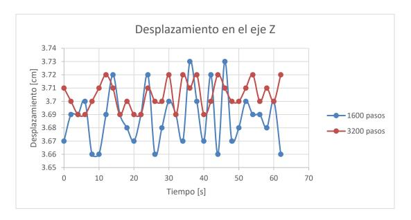
El desplazamiento promedio en el eje Z en la configuración de 1600 pasos es de 3.68 *cm* y en la configuración de 3200 pasos es de 3.7 *cm*.
