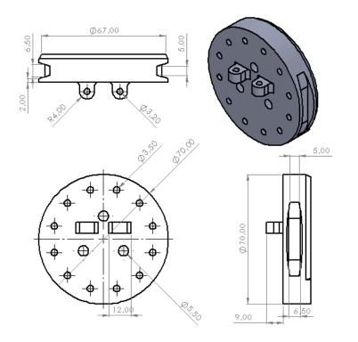
La herramienta de montura de censado se encarga de tomar las muestras de humedad del suelo (tierra) mediante la instalación de un sensor de humedad capacitivo.
