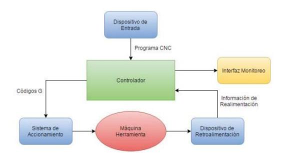
Figura 2: Principio de funcionamiento de una máquina CNC
