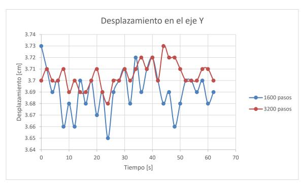
Gráfica 4: Desplazamiento en eje Y del prototipo
