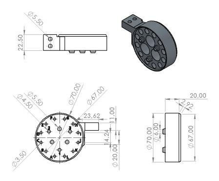
Figura 21: Herramienta de montura de censado
