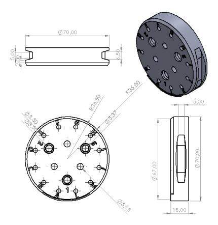
La herramienta de montura de inyección de semillas fue diseñada con el propósito de succionar las semillas colocadas en la herramienta matricial de semillas y posteriormente inyectarlas en la tierra mediante una jeringa ensamblada.
