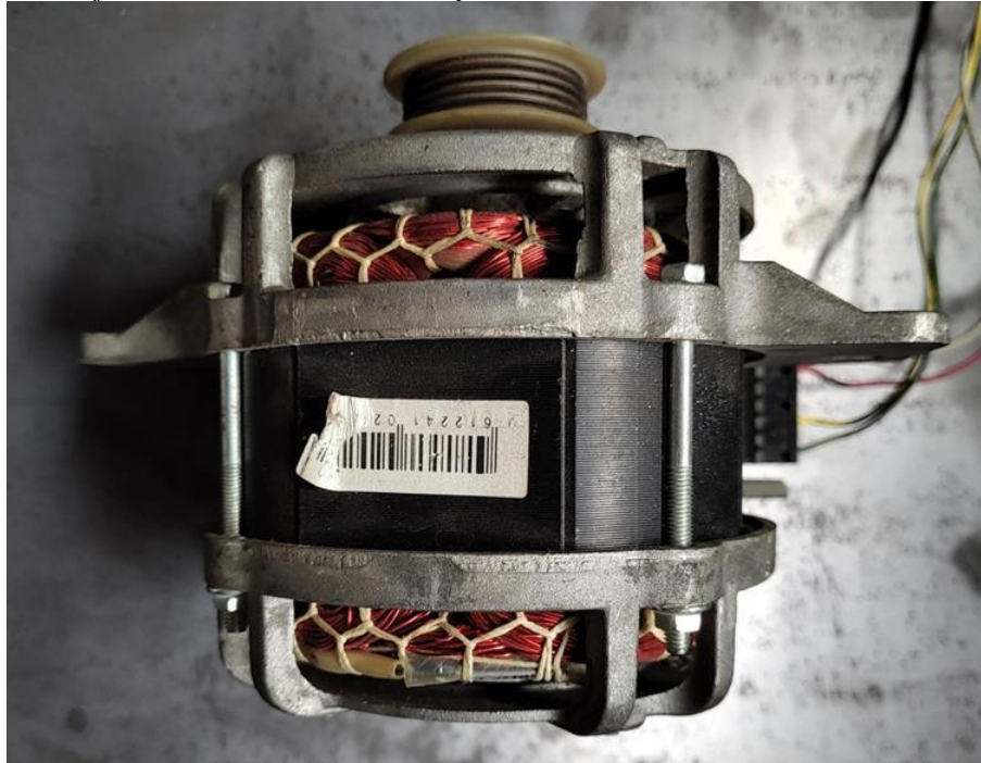
Figura 28 Motor ref w 10006415 de 1/4 de Hp
