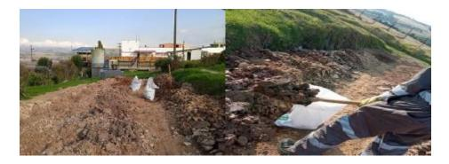
**Ilustración 29-30.** Toma de muestra en depósito de lodo residual planta de tratamiento de agua potable PTAP Veolia Tunja.
