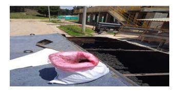
**Ilustración 31.** Toma de muestra de contenedor de lodo residual planta de tratamiento de agua residual PTAR Veolia Tunja.
