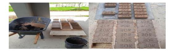
**Ilustración 42-43.** Moldeado y secado de ladrillos 70%
