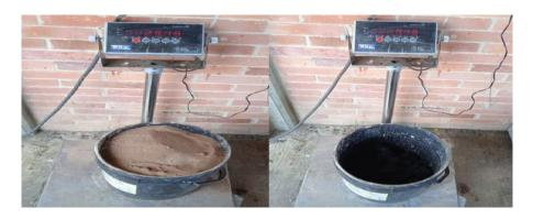
Ilustración **33-34.** Pesaje de arcilla y lodo residual para ladrillos con porcentaje 80% - 20% con lodo residual PTAP.
