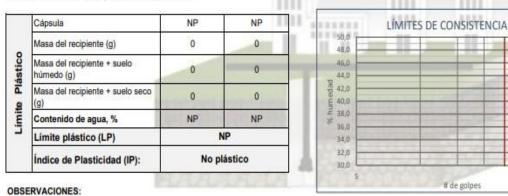
Figura 8. Ensayo límites de consistencia PTAP.
