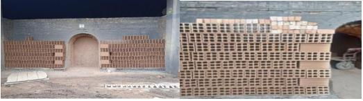
**Ilustración 51-52-53-54.** Proceso de horneado de ladrillos en instalaciones de ladrillera el rubí S.A.S.
