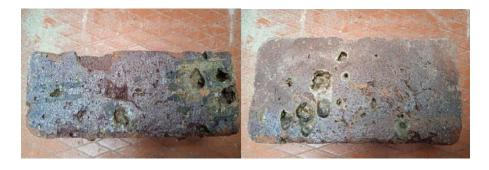
Ilustración 59-60. Ladrillos de lodo residual PTAP con huecos.
