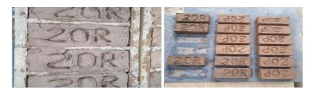
**Ilustración 38-39.** Fisuras en muestras por exceso de humedad y retiro de muestras defectuosas.
