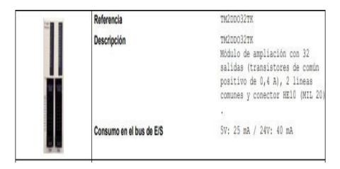
Figura 30. Módulo de expansión salidas digitales PLC Schneider Electric m221.
