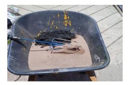
**Ilustración 36.** Mezcla de arcilla con lodo residual PTAR
