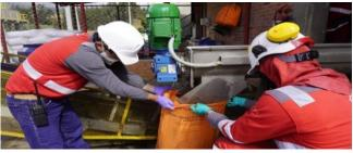
Ilustración 21-22-23. Toma de muestras lodo residual PTAR.
