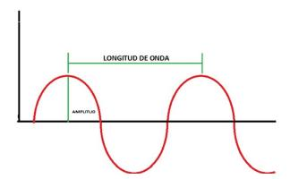
*Nota* la figura muestra las propiedades de una onda electromagnética, entre las cuales se pueden observar la longitud de onda y la amplificación Fuente: (Briceño y otros, 2016).
