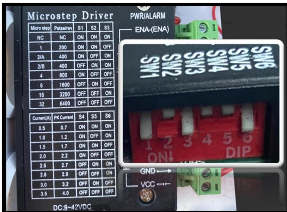
Luego de haber configurado el driver a 400 pulsos/rev, se continua con los cálculos correspondientes para determinar el número de pasos necesarios y los tiempos de recorrido y espera, correspondientes a los ángulos azimutales definidos; como se muestra en la Tabla 12 y Tabla 13.
