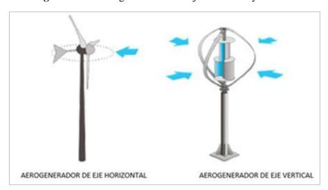
**Figura 2.2.1:** Aerogeneradores de eje horizontal y vertical.
