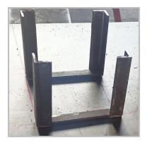
Figura 3.7.4: Acople del soporte principal y auxiliar para el desplazamiento vertical.
