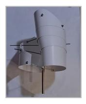
Figura 3.7.25: Ensamblado del rotor Savonius de geometría helicoidal.
