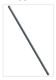
Viendo la figura 3.4.5 se puede contemplar el modelado del eje que soportará los rotores y será el encargado de transmitir el movimiento generado por la interacción entre las corrientes de viento y los rotores.
