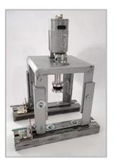
Como se aprecia en la figura 3.7.6, el ensamble de la estructura permite el posicionamiento y fijamiento del generador eléctrico y el paso de su eje con polea para la transmisión del movimiento de generado por el rotor eólico.
