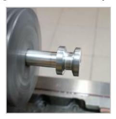
Figura 3.7.10: Eje con polea fabricado.
