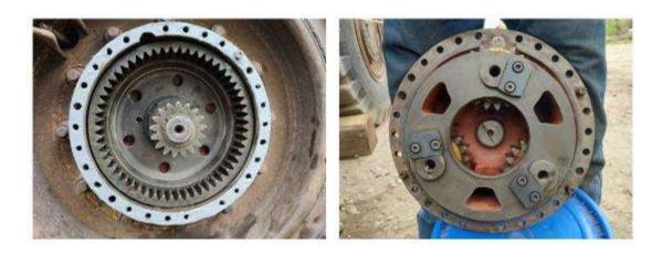
Nota. Fuente: El autor - Transmisión planetaria mando final dúmper Volvo modelo A25C
