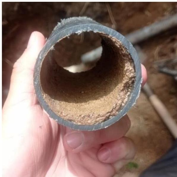
*Ilustración 9: Identificación de calcificación en tubería antigua; Bocatoma el Carrizal (2023)*
