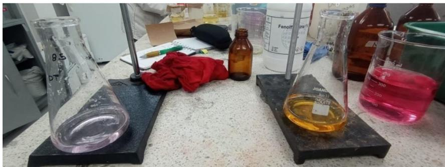
Ilustración 23: Registro de prueba Dureza Cálctica - titulación; fuente propia
