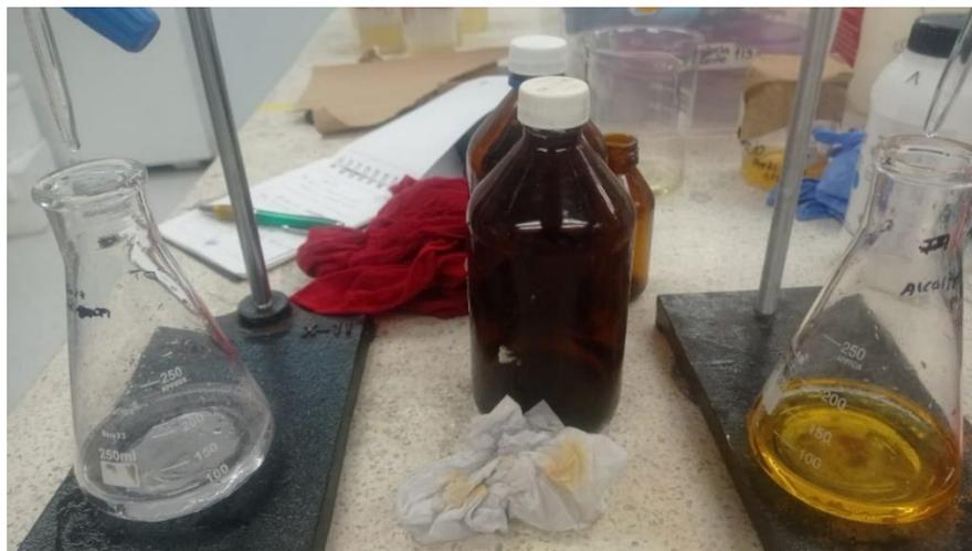
Ilustración 21: Proceso de titulación para identificar Alcalinidad
