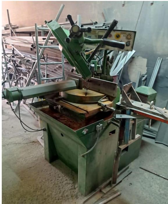
*Nota: Imagen de maquinaria utilizada para el corte de tubería metálica.*
